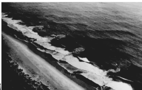
摇摇图 1-5 裂流系统 (摇摇图 1-5)
