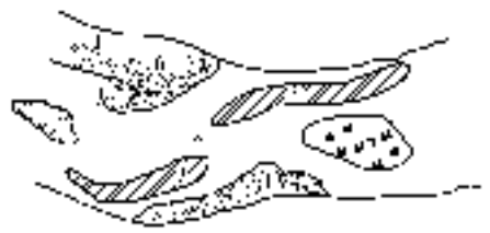
图 2-5 河流主槽中各种成形淤积体 1-边滩;2-浅滩;3-深槽;4-江心滩;5-江心洲;6-沙嘴
