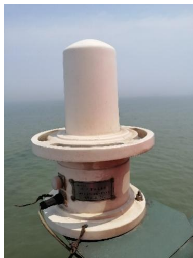
图 1-9 天津港北防波堤灯桩雷达应答器
