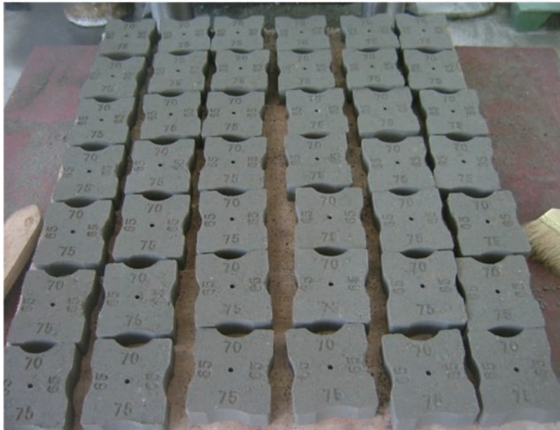
钢筋保护层垫块成品
