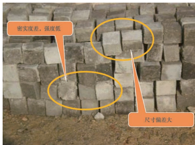
不符合要求的保护层垫块
